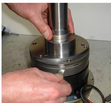
A continuación, añada el casquillo deslizante, el puente y las piezas de compensación de peso. Coloque el primer casquillo deslizante sobre el eje con la superficie plana hacia abajo.
