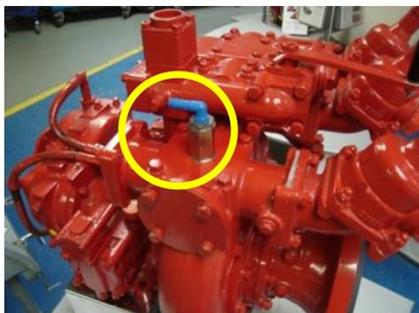
2. Retire la TRV con una llave ajustable adecuada capaz de abrazar el cuerpo principal de la TRV.
