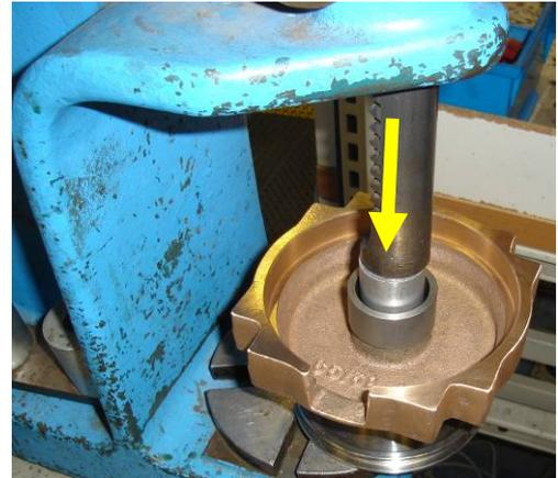
19. Coloque la herramienta extractora del resorte circular dentro de la herramienta de instalación, apoyada en el resorte circular. Al aplicar presión sobre la herramienta de instalación, ejerciendo una presión manual adecuada, el resorte circular se irá empujando hacia abajo hasta quedar instalado en la estría dentro de la camisa del cilindro. Esto fija y retiene el conjunto de piezas del sello, tal como se indica abajo.
