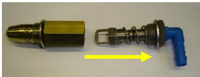
5. Para realizar una inspección detallada, puede empujar y extraer el actuador térmico (Nº comp. 57053) de la carcasa principal del extremo cónico
