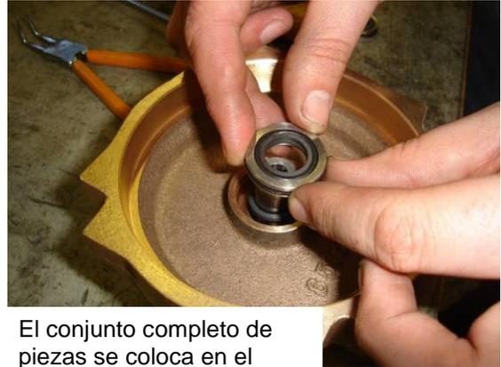
El conjunto completo de piezas se coloca en el cilindro utilizando el eje del pistón como guía de
