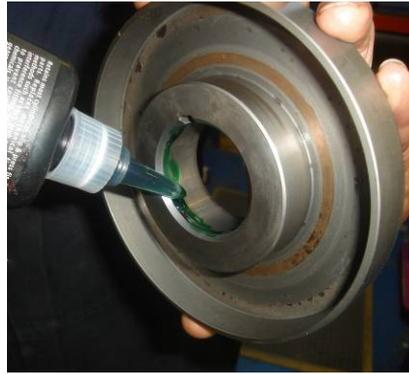
Coloque el rotor sobre el eje, alineándolo correctamente con la llave del eje, y presione hasta que quede apoyado de manera firme sobre el estátor de debajo. Permita que el producto Loctite se solidifique.
