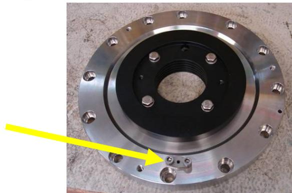
Vuelva a colocar la placa cubierta de alta presión sobre el cuerpo de la bomba. Sostenga con 12 tornillos de cabeza hexagonal y ajuste a una tensión de 44 Nm. Aplique Molykote P37 o un producto similar debajo de la cabeza de los tornillos para evitar el gripado.
