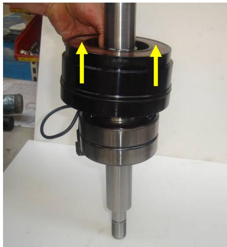
Los dos cojinetes que quedan en el eje requieren la presión de una herramienta adecuada para separar el eje de los cojinetes. Sostenga los cojinetes por debajo y fuerce el eje hacia abajo para separarlo de los cojinetes.
