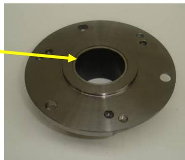
Fije la placa de fricción del embrague (parte de 65017/004) al accionamiento excéntrico utilizando los (3) tornillos y arandelas provistos por el fabricante del embrague. Aplique Loctite 243 sobre las roscas; ajuste a una torsión de 28 Nm.
