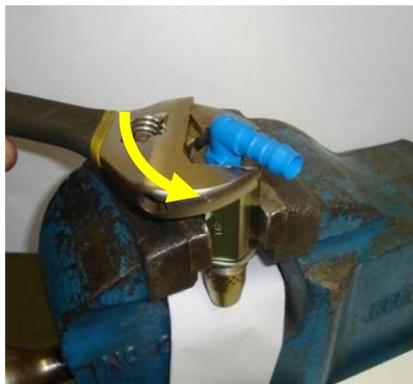
4. Las piezas internas de la TRV se pueden deslizar para salir de la carcasa
