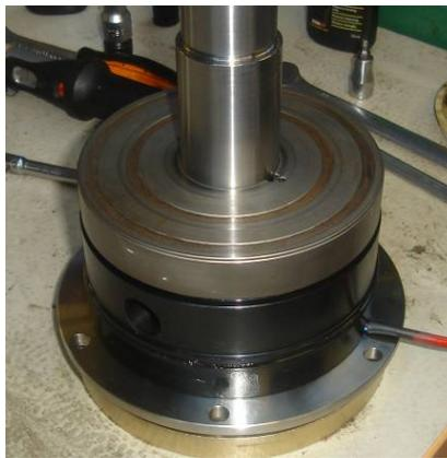
2. Los modelos más modernos de las unidades de embrague se mantienen en posición presionando sobre el eje. No se necesita Loctite.
