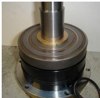
El accionamiento excéntrico y la placa de fricción montados anteriormente ya pueden bajarse por el eje hasta la cara del rotor del embrague. Verifique el espacio entre la placa de fricción y el rotor; tendría que ser de 0,3 mm.
