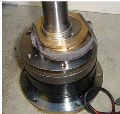
Coloque las piezas de compensación de peso sobre el segundo casquillo deslizante y sujete todo al accionamiento excéntrico de debajo utilizando dos tornillos Allen.
