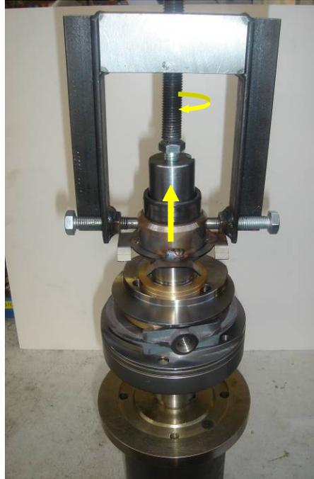
Nota: para retirar la mayoría de los componentes del eje solo basta con deslizarlos (conjunto de piezas del deflector, cuñas, conj. de piezas de compensación de peso/controles deslizantes/puente/piezas excéntricas), pero el rotor/estátor del embrague y dos cojinetes del eje requieren una extracción más cuidadosa.
