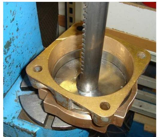
20. Ya puede retirar el pistón del cilindro y volver a instalar el cilindro en la orientación correcta. También puede ejercer presión manual para forzar el pistón a través del sello hasta que el pistón quede ubicado en el fondo del cilindro.
