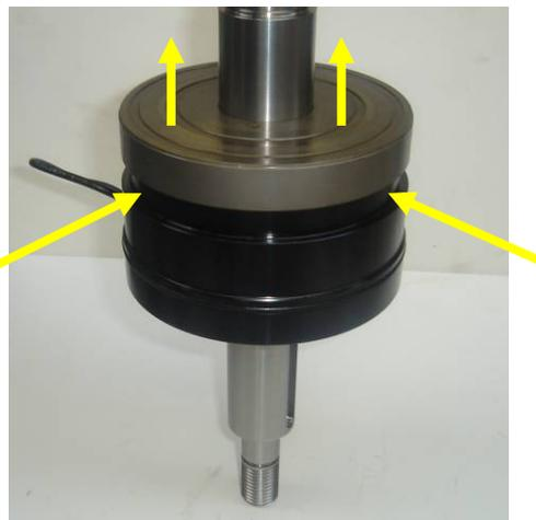
A continuación, ya puede hacer presión para extraer el estátor del embrague utilizando una herramienta adecuada o dando golpes leves con un martillo de cabeza blanda por el borde externo.
