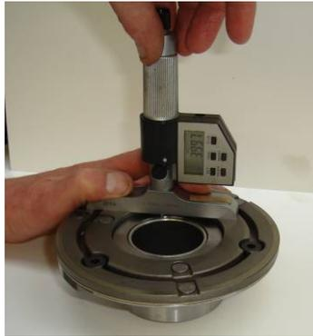
Debe quedar un espacio de entre de 0,24 y 0,40 mm entre el rotor del embrague y la placa de fricción. Podrá conseguir el espacio necesario al seleccionar una cuña apropiada de la tabla que aparece al final de esta sección. Por ej., si el espacio es de 4,1 mm, añada 0,3 mm para el espacio; por lo tanto necesitará una cuña de 4,4 mm. Las cuñas de 4,4 mm se clasifican por ser de color verde. Véase la tabla en la página 45.
