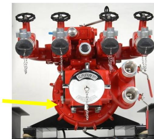
Para retirar y volver a instalar el anillo de desgaste frontal en el diámetro de alojamiento de la placa cubierta de aspiración, afloje los 4 tornillos de cabeza hexagonal hueca y las arandelas correspondientes
