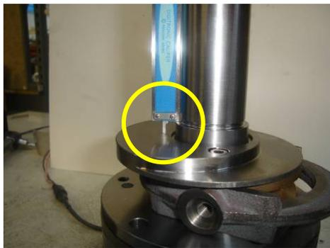
Coloque las cuñas sobre el eje, equivalente a 8,3 mm. La tabla de la página 45 muestra las opciones de cuñas. Coloque el conjunto de piezas del deflector sobre las cuñas y compruebe el espacio entre la parte superior de la cuña y el deflector; el espacio necesario es de entre 0,05 y 0,15 mm.
