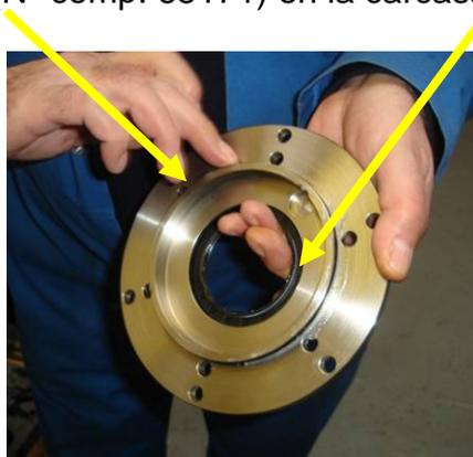
Asegure la carcasa del sello al estátor del embrague con 6 tornillos MS164/20. Aplique Loctite 243 sobre las roscas y ajuste a una torsión de 20kN.
