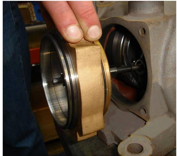
El conjunto de piezas del cilindro y el pistón se deslizan por la varilla guía y conectarán con el puente.
